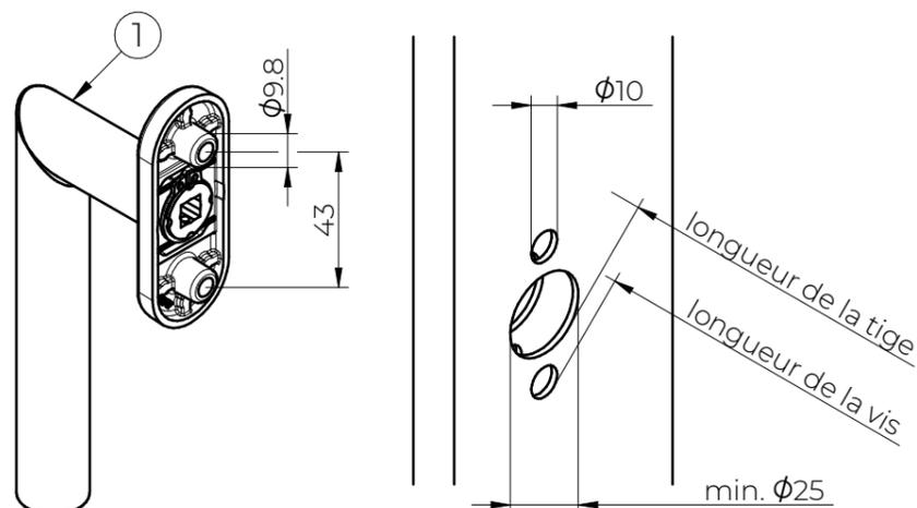
Si les trous de fixation sont plus gros que 10mm, utiliser les douilles de réduction Gr. 9,5 x 11,5mm 902100032, BE 100997
